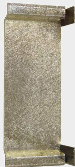
Pièce avec de la métallisation nickel
