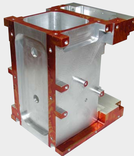
Pièce masquée prête pour le traitement d'anodisation.
