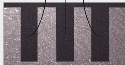
Pores de l'aluminium scellés
